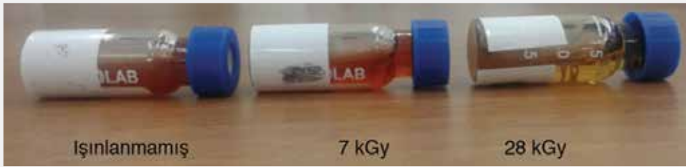
Şekil 4. Işınlama üzerine metil turuncusu-polimer jel dozimetrede ortaya çıkan renk değişikliği
